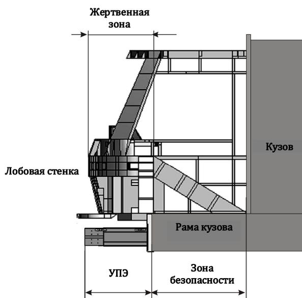
Рисунок 4 – Конструктивно-компоновочная схема кабины с СПБ
