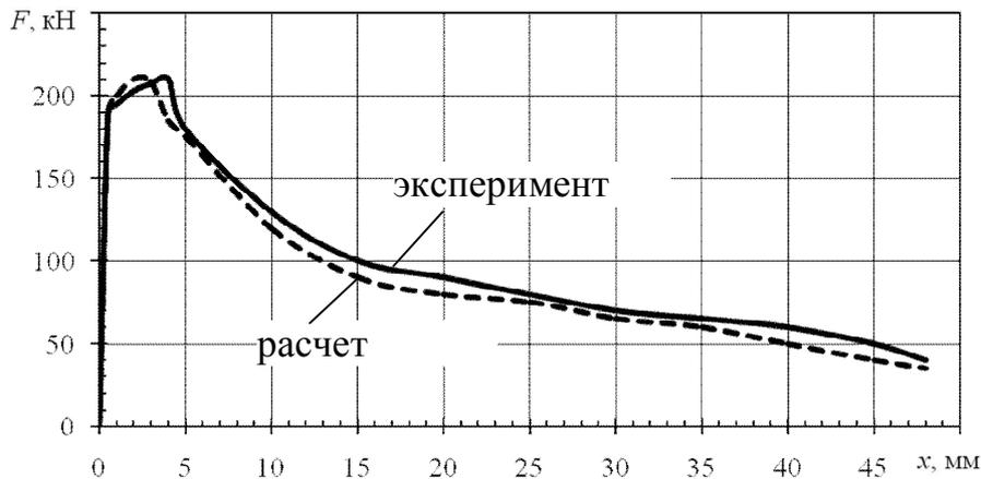
Рисунок 3 – Диаграммы деформирования перфорированной трубы при сжатии
