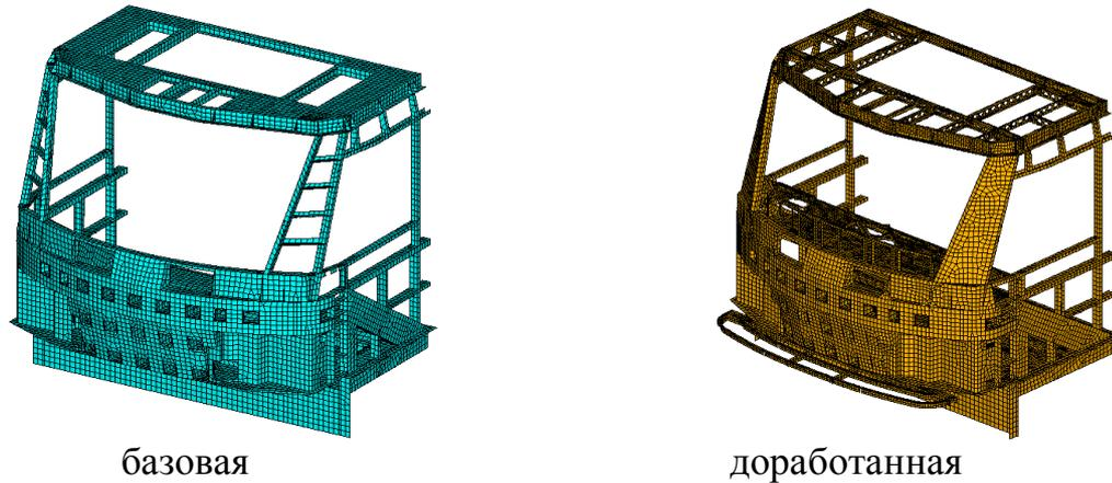
Рисунок 9 – Конечно-элементные схемы конструкций каркаса кабины
